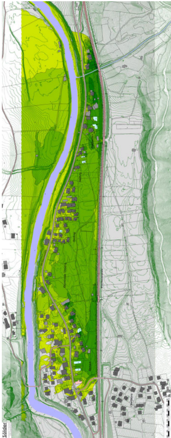
Abbildung 22: Differenzlärnkarte Variante 1, Immissionshöhe 4,0 m über Gelände
