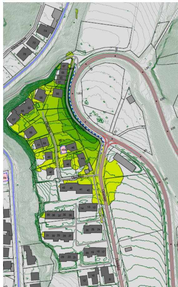
Abbildung 24: Differenzlärmkarte, Immissionshöhe 4,0 m über Gelände
