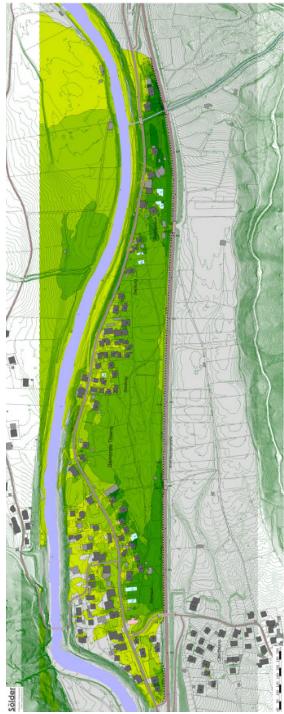
Abbildung 23: Differenzlärnkarte Variante 2, Immissionshöhe 4,0 m über Gelände
