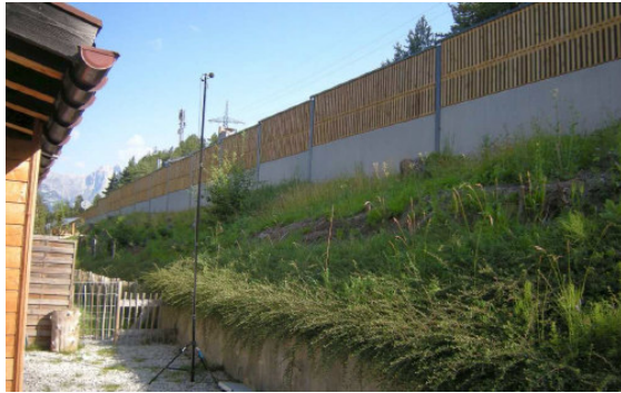
Abbildung 5: Lärmmessung zur Evaluierung der Lärmschutzwände
