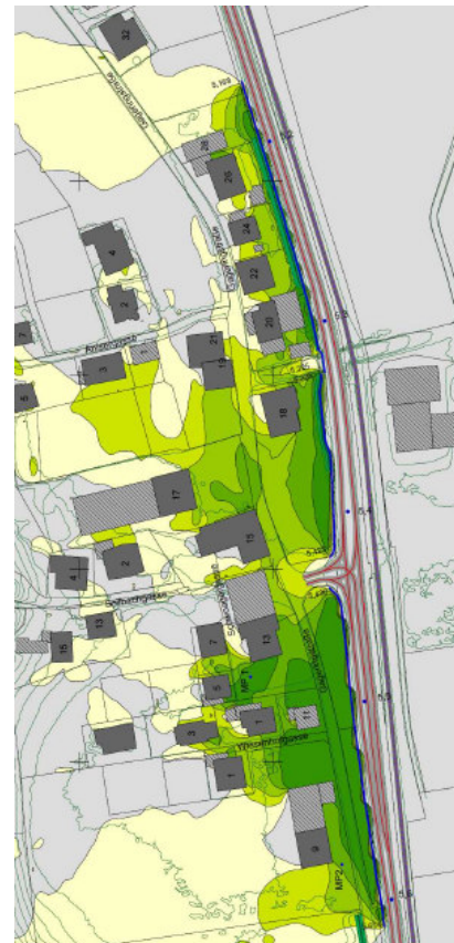
Abbildung 2: Differenzlärmmkarte Lärmschutz Gagering, km 5,1 bis km 5,6
